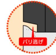
基礎天端モルタルの中央部の凹みに合わせて、底面端部を削った形状。浮きがなく、しっかりと据え付けできます。
